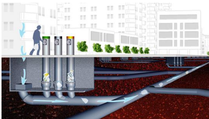
Rys. 8. Wizualizacja pneumatycznego systemu transportu odpadów komunalnych
